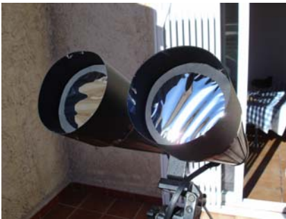
Filtros tipo lámina colocados sobre unos prismáticos. Cada filtro está incorporado a un adaptador de cartulina negra de forma cilíndrica.
