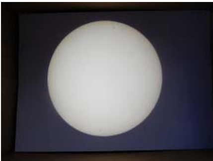
Imagen del Sol proyectada por un prismático 10 x 50 sobre un folio tamaño A4 que actúa de pantalla de proyección
