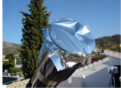
Filtro de Sol tipo lámina (no confundir con papel de aluminio) sobre objetivo del telescopio. Se trata de un filtro económico pero frágil y con caducidad.
