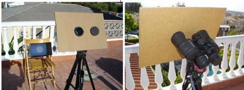
Detalles sobre la forma de utilizar unos prismáticos para obtener una imagen del Sol proyectada. Obsérvese que uno de los tapones de los objetivos está colocado para evitar daños. Además, la imagen del Sol se proyecta sobre el interior de una caja situada en la sombra del "quitasol" (lámina de cartón) a fin de aumentar el contraste.
