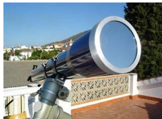
Filtro de Sol sobre objetivo del telescopio. Se trata de un filtro seguro que mantiene "frío" el telescopio.
