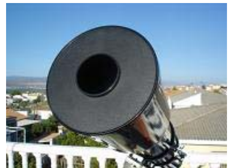
Reducción de la entrada de luz en el tubo óptico del telescopio a fin de evitar el deterioro de sus elementos, principalmente los ópticos.
